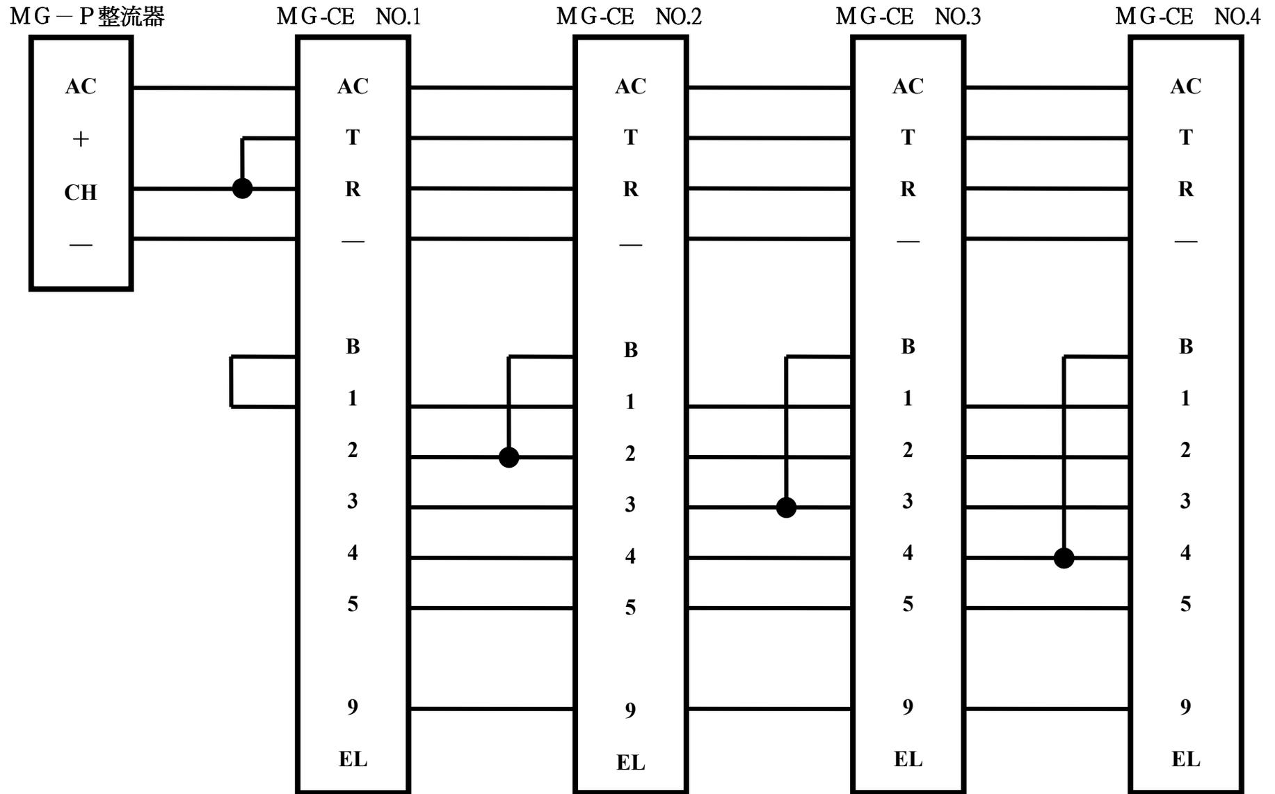
MG-C 型對講機變更為 MG-A 型對講機時 EL 無法做 10 號使用，T · R 接到整流器的 CH 即可，C 型對講機上的 CH 為無迴路的空接點，整流器(+)電源不接· 整流器電壓：AC110V / AC24V · DC12V 對講機：長 215mm 寬 95mm 高 80mm
